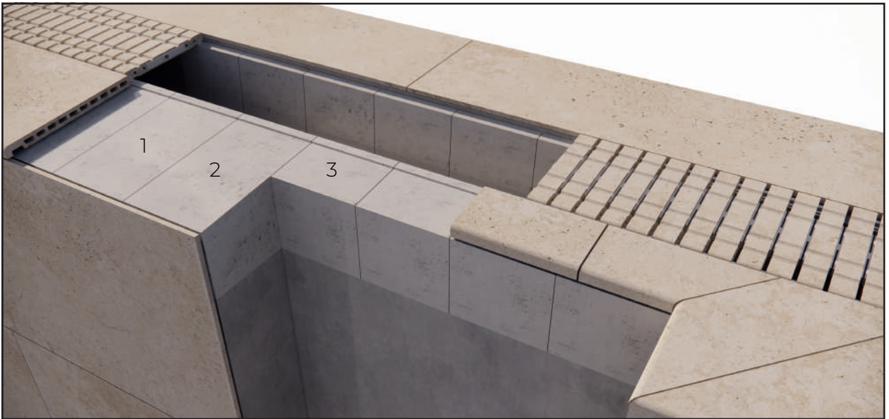
Ubicación de los diferentes tipos de bloque en zona de acceso Location of the different block types in access area
